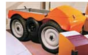
↑ Еще один механический «мул», построенный с прицепом на использование в американской армии, – амфибия DAF Porter, в которой колеса каждого борта приводились во вращение расположенными по центру кузова катками посредством силы трения. Опытный образец прошел испытания в 1965 году, но так и не получил дальнейшей путевки в жизнь
