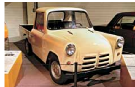
↑ А этот пикап прямого отношения к компании «DAF» не имеет: его разработали в США по заказу крупной газодобывающей компании «ARCLA», использовав все основные агрегаты серийной «малолитражки» DAF 750 – двигатель, трансмиссию Variomatic, подвеску. В 1964 году на судостроительной фирме «Razorback Boats» из Малверна (штат Арканзас) собрали 97 таких пикапов, получивших марку Handywagon. Дальнейшего развития проект не получил, поскольку создатели машины не смогли снизить себестоимость пикапа до $1000, как того требовал владделец ARCLA для заказа следующей партии. Выпущенные же в 1964-м образцы эксплуатировались порядка 10 лет. На сегодняшний день известно о трех сохранившихся образцах
