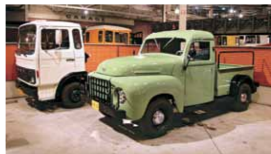
↓ Пикап DAF A 117 с виду вылитый «американец»! Такие грузовички с карбюраторным двигателем Hercules (91 л.с.) выпускались в первой половине 1950-х для поставки в армии голландских колоний. Пикап для музея восстановили из обломков двух машин, найденных волонтерами на Антильских островах. На заднем плане – среднетоннажное шасси DAF FA 700 DE выпуска 1978 года
