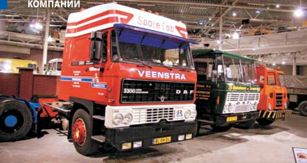
↑ А так выглядел первый Space Cab – тягач DAF FT 3300 DKX, задавший в начале восьмидесятых новый стандарт в кабинах для дальнемагистральных перевозок. Грузовик из музея выпущен в 1984 году и имеет пробег 2 миллиона километров, которые он «набегал» за 23 года непрерывной эксплуатации
