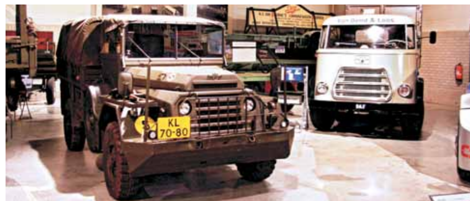
↑ Еще один военный DAF с бортовой трансмиссией – легкий артиллерийский тягач YA126. В 1953-1959 гг. было произведено 3496 таких машин. На заднем плане виден гражданский седельный тягач DAF T 1300 DA со 100-сильным дизелем, выпущенный в 1961 году
