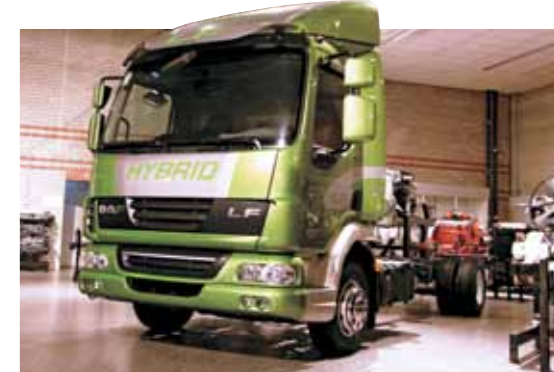
→ Надо же – старый знакомый! Этот гибридный DAF LF 45 я до сих пор помню по выставке «IAA2010» (тот салон, к слову, вообще можно было назвать первым настоящим парадом гибридов в «грузовом» мире). Силовой агрегат машины состоит из 4,5-литрового дизеля с автоматизированной 6-ступенчатой коробкой и вспомогательного электромотора на 44 кВт, установленного после сцепления. Блок литий-ионных тяговых батарей смонтирован в специальном ящике на правом лонжероне рамы и позволяет проехать без помощи ДВС до 2 километров
