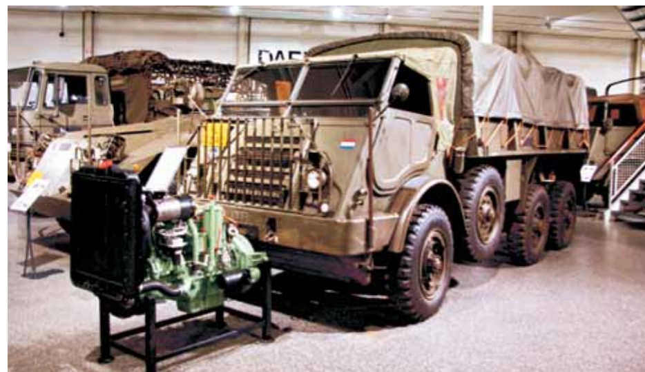
↑ Длительное время DAF являлся поставщиком техники для вооруженных сил Нидерландов, выпуская широкую гамму военной техники весьма нетривиальной конструкции. Первенцами стали полноприводные грузовики серии Y, разработанные в начале пятидесятых. Среди них была и трехосная модель YA328 полной массой 9 т с бортовой трансмиссией: в 1953-1958 гг. вооруженные силы Нидерландов получили 4825 таких грузовиков
