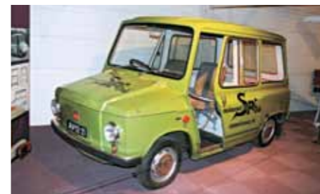
↑ Еще один пример стороннего «творчества» с использованием платформы «малолитражки» DAF – почтовый фургон Tjorven, разработанный шведской компанией «Kalmar Verkstads AB» для шведского почтового ведомства. Особенности машины стали пластик кузов, правое расположение органов управления и единственная сдвижная дверь с правой стороны. После успешного тестирования прототипов, построенных в 1965-1966 гг. на базе DAF 33, почта Швеции заказала сразу тысячу аналогичных фургонычков. В серийное производство Tjorven пошел с 1968 года уже на платформе более новой модели DAF 44. Спустя год появилась и «гражданская» версия – со сдвижными дверями с обеих сторон и пассажирским сиденьем рядом с водителем: реализация таких машин под маркой Kalmar-DAF шла в Западной Европе через дафовскую дилерскую сеть. Всего до 1971 года выпустили 2170 шт.
