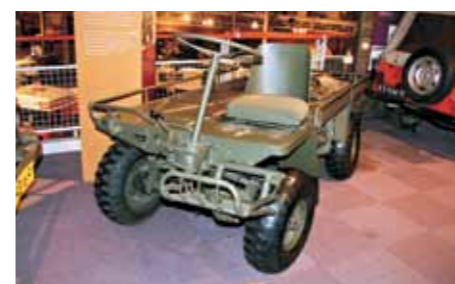
↑ DAF YM 500 Pony – прототип легкого авиадесантируемого транспортера, разработанного в 1963 году по заказу военного ведомства США и призванного повысить мобильность пехоты на пересеченной местности. Под платформой между мостами был поперечно расположен силовой агрегат из 500-кубового «опозитника» воздушного охлаждения и клиноременного вариатора. С ведомого шкива вариатора крутящий момент передавался на «раздатку», выполненную в общем корпусе с редуктором заднего моста, а затем и на передний мост. Управлять транспортером можно было, даже просто идя позади платформы – для этого требовалось лишь переставить рулевое колесо. Серийное производство «военного пони» развернуто не было – дело ограничилось постройкой нескольких образцов для испытаний
