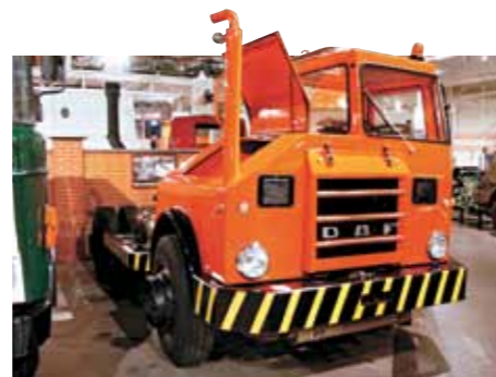
↑ DAF T 1800 DF – «седельник» для транспортировки контейнеров в морских портах и на промышленных территориях. Он оснащался весьма скромным по отдаче мотором (135 л.с.), однако благодаря «автомату» Allison и очень большому передаточному отношению ведущего моста мог работать в составе автопоезда общим весом до 65 т! Музейный экземпляр выпущен в 1969 году
