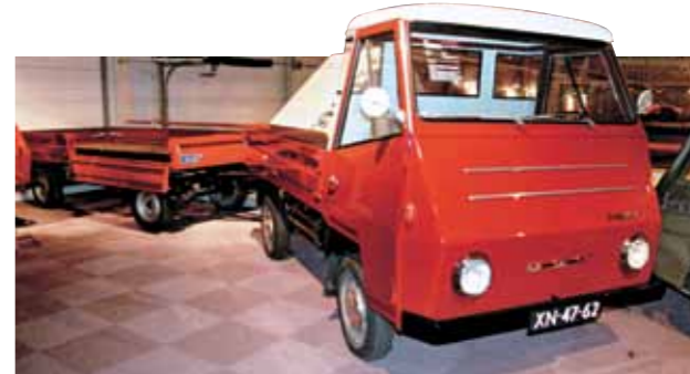
↑ Зато спустя пять лет серийным стал гражданский грузовичок DAF Pony, созданный на агрегатах DAF 44 (с 40-сильным мотором и вариатором). Базовая модель DAF 1010 с бортовой платформой имела грузоподъемность 750 кг и еще столько же могла везти в двухосном прицепе DAF 1030. Существовал и автопоезд в составе седельного тягача и одноосного полуприцепа DAF 1050 грузоподъемностью 1500 кг. В 1968-1969 гг. в Эйндховене успели собрать порядка 700 Pony, но затем производство остановили в связи с низким спросом
