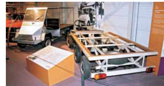
↑ Еще один механический «мул», построенный с прицепом на использование в американской армии, – амфибия DAF Porter, в которой колеса каждого борта приводились во вращение расположенными по центру кузова катками посредством силы трения. Опытный образец прошел испытания в 1965 году, но так и не получил дальнейшей путевки в жизнь
