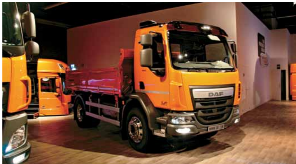
DAF LF больше всего известен у нас в ипостаси низкорамного развозного фургончика, а между тем «эль-эфки» выпускаются и в строительном исполнении – с большими колесами и высокой рамой. Например, как этот 250-сильный самосвал
