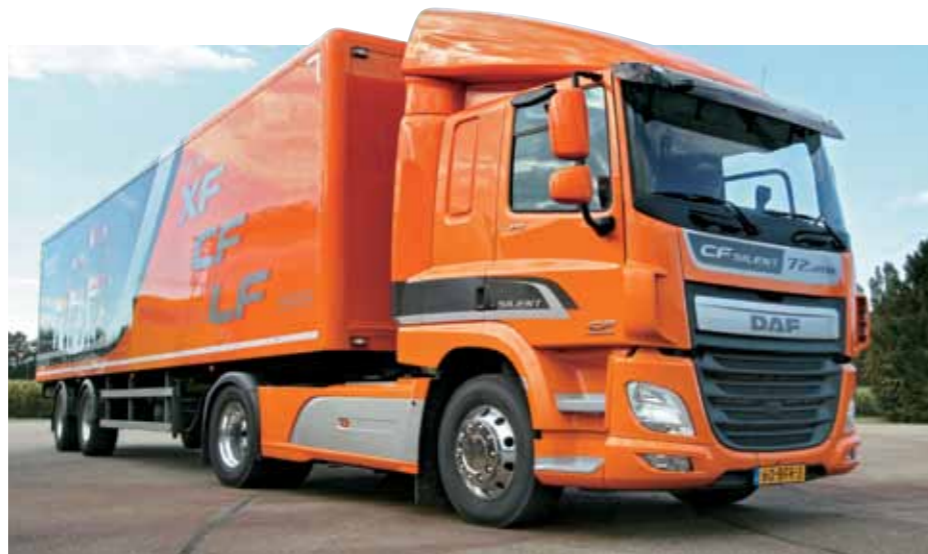
Тягач DAF CF в исполнении Silent разработан специально для ночных перевозок грузов в жилых зонах и отличается сниженным до 72 дБА уровнем внешнего шума. Полуприцеп фирмы «Burg» – тоже субгородской: для улучшения маневренности у него задняя ось на поворотном круге с принудительным управлением от тяги, соединенной с седлом
