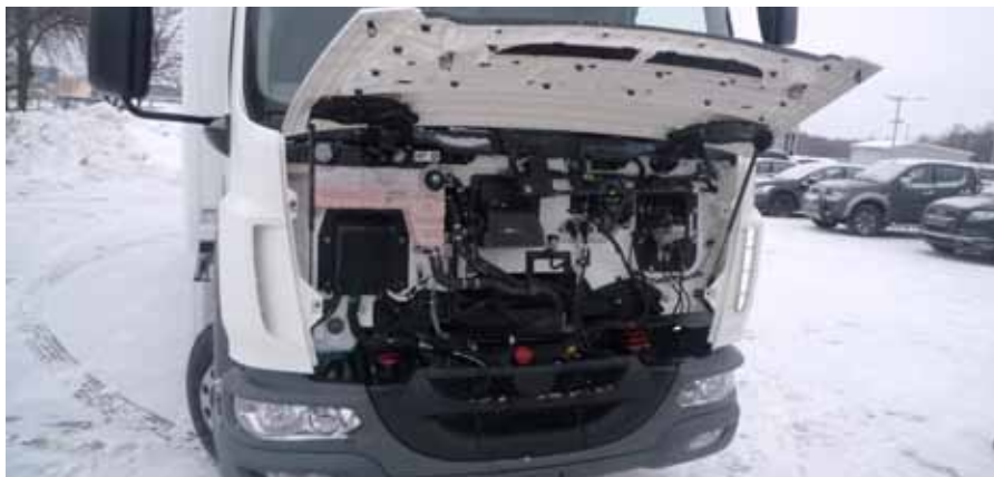
Откидная панель обеспечивает доступ к целому ряду устройств
