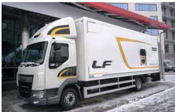
DAF LF Euro 5 полной массой 19 т, оснащенный короткой кабиной и кузовом сербской фирмы ЕМА
