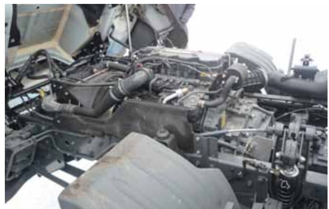
Автомобили комплектуются дизельными двигателями PACCAR FR и GR
