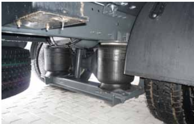
19-тонная модель снабжена усиленным ведущим мостом с пневмоподвеской
