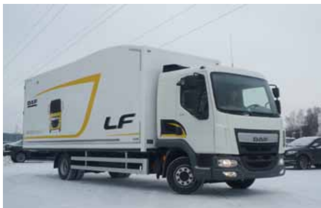
Вариант с удлиненной кабиной и фургоном ЕМА с аэродинамичной формой крыши
