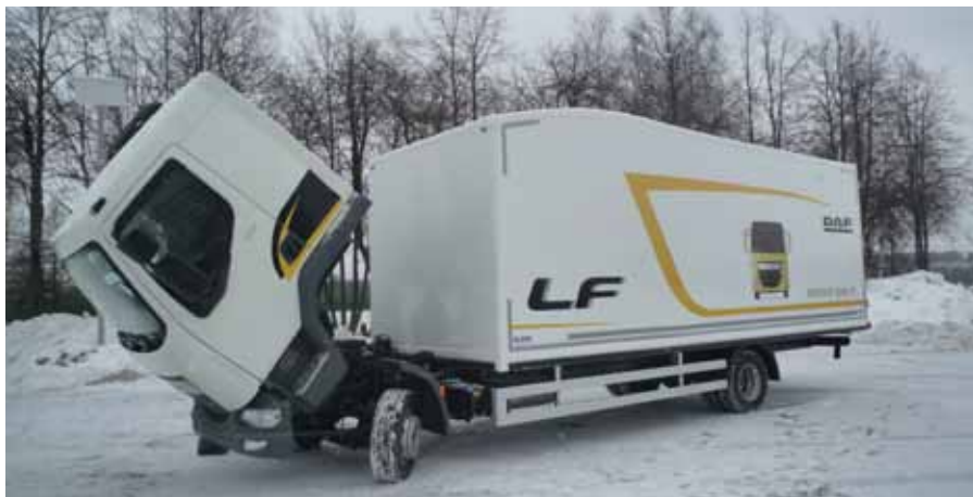
Наклоняемая кабина облегчает обслуживание силового агрегата
